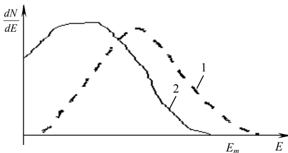
Рис.3.5. Энергетический спектр \beta^- -частиц 1 – теоретическая кривая по формуле (3.12); 2 – экспериментальные данные
