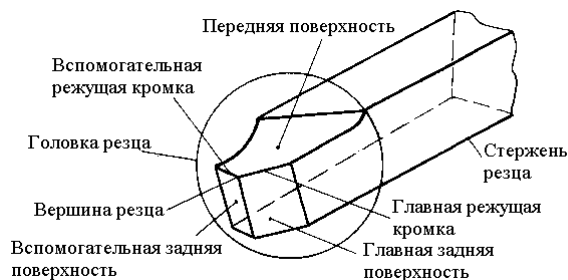
Рис. 9. Элементы токарного резца
