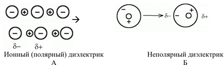
Рис. 17. Примеры поляризации диэлектриков при внесении во внешнее электрическое поле.
